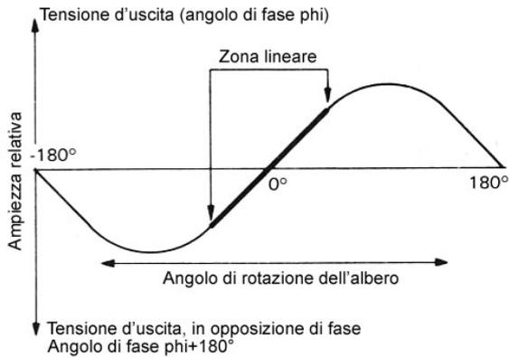
fig. 3.5 Caratteristica d'uscita di un RVDT
